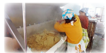
上は「製麹機」。麹菌は雑菌に弱いので、機械や道具の消毒も徹底します!
