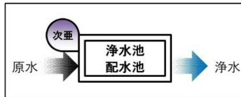
図 2-2-4 消毒のみによる処理工程
