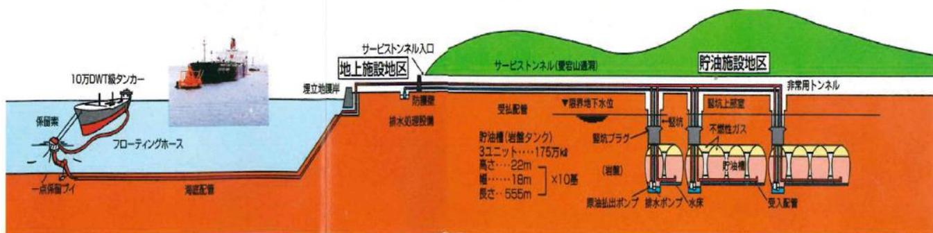
水封式地下石油備蓄とは、地下水面下の岩盤内に空洞を掘ってそこに原油を貯蔵する方式です。自然の地下水に加え、一部水封トンネルから水を供給して空洞の周りの水圧を貯蔵された原油の圧力より高くすることによって、漏油、漏気を防止するシステムです。
