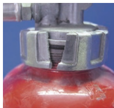
× キャップの破損
