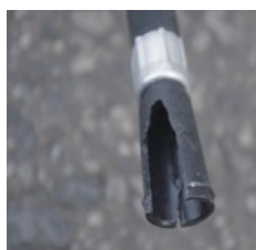
× ノズルの破損
