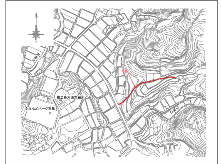
配水管布設工 ポリエチレン管1種(2層管) φ30 L=246m 排泥弁φ25 N=1基 小型空気弁φ13 N=1基
