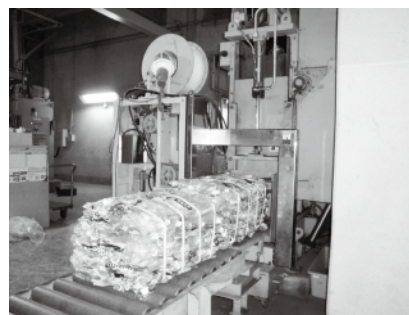
修繕されたペットボトル圧縮梱包機
