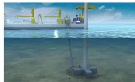
根固め・洗掘防止工のイメージ
