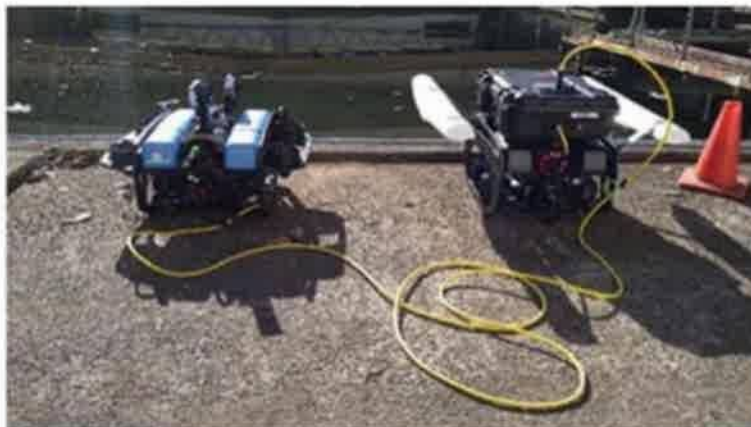
図 AUV-ASV 連結システム一式の外観（左）とシステム概要（右）（銚子沖洋上風力発電設での点検事例）
