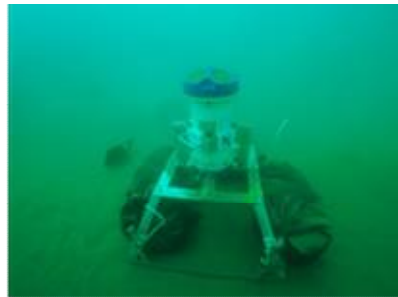
波浪計／流速計センサーの設置例
