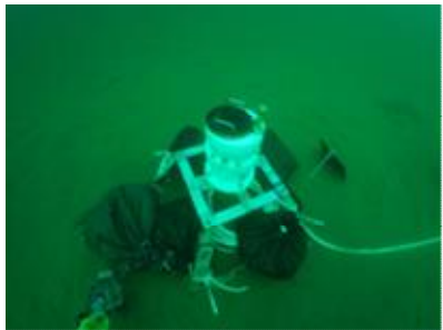
波浪計／流速計センサーの設置例
