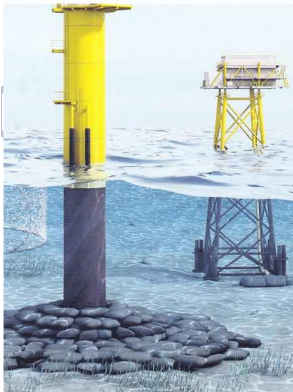
洗掘防止工の概念図 (左手前:モノパイル式) (右奥:ジャケット式)
