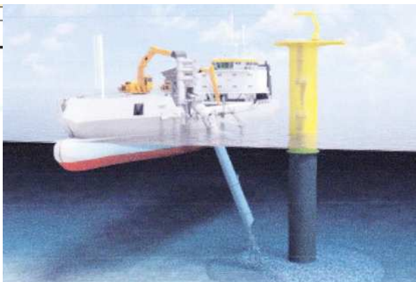
洗掘防止工の 施工概念図 (出典: Jan De Nul 社ホームページ)
