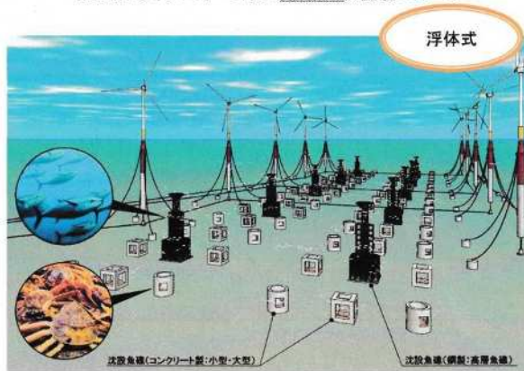
浮体式洋上ウィンドファーム内での資源育成用大水深魚礁設置のイメージ
