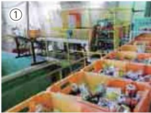
①ペットボトル、アルミ、スチール、ピンは一緒に自動選別機のラインにのり、自動でそれぞれに分別される。分別には風や磁力を利用しているが、つぶれたペットボトルや缶は風で弾き飛ばされないため分別できない。
