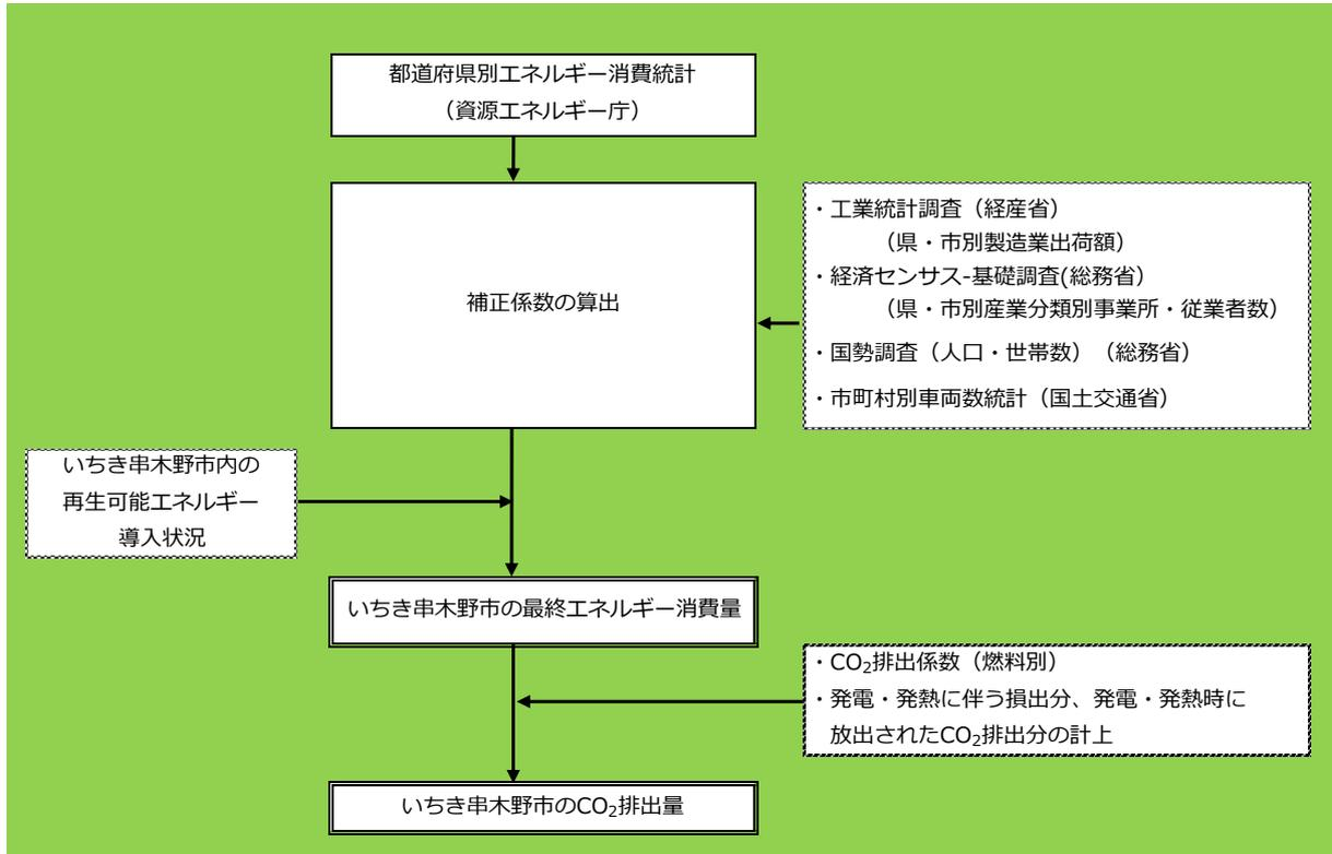
図3.3-2 最終エネルギー消費量・CO<sub>2</sub>排出量の推計方法
