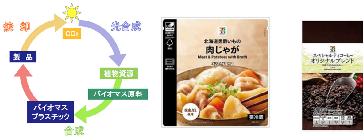
図 4-5-17 バイオマスプラスチック利用によるカーボンニュートラル及びセブンイレブン導入事例 出典：日本バイオマスプラスチック協会 バイオマスプラスチック入門 環境省 バイオマスプラスチック導入事例集
